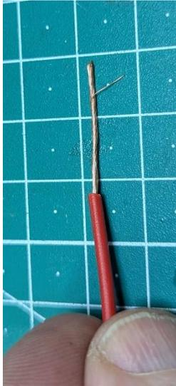
9. jetzt die Beiliegende rote Litze etwa 2cm abisolieren und die kupferadern verdrillen. Und die Litze durch die beiden Löcher der Schalter Kontakte fädeln, die noch frei sind und dann beide Kontakte verlöten.
