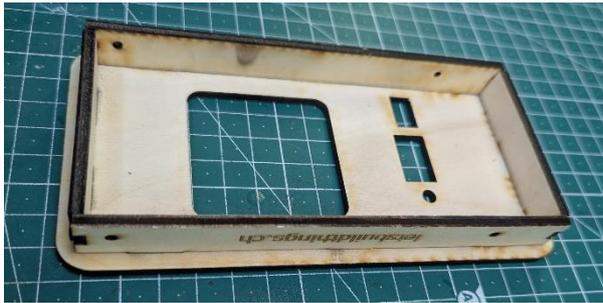
3. Schiebe das Hinterteil in die Nuten der Seitenteile, ebenfalls gern mit Holzleim.
