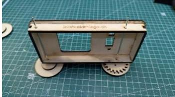
2. Fädle zuerst die Hinterachse durchs Chassis, stecke die beiden übrigen Räder auf und klopfe sie vorsichtig fest, bis die Achse auf beiden Seiten etwa bündig sitzt. Nicht weiterhämmern – sonst verbiegt sich die Achse.
