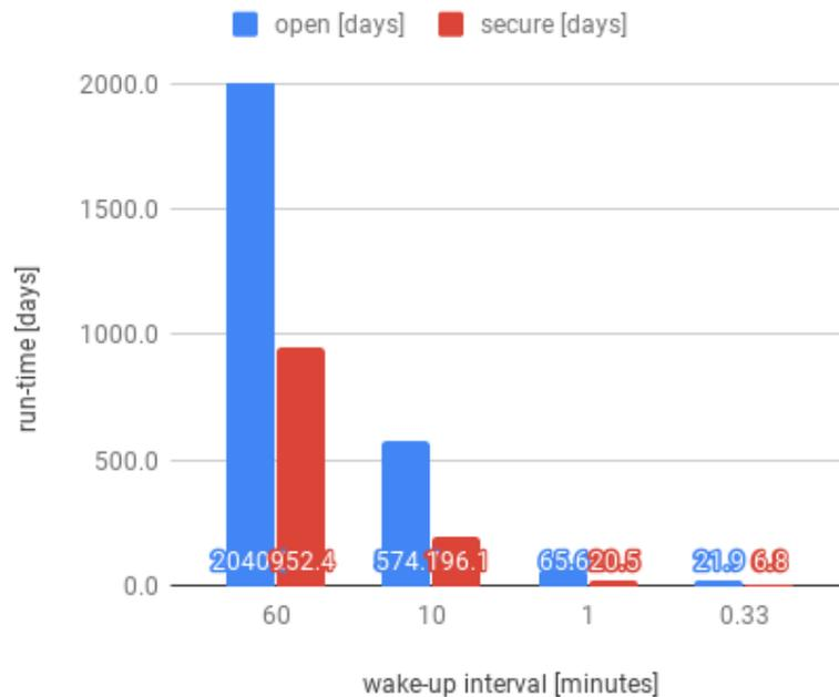
Abbildung 16: ESP32 Deep-Sleep Laufzeit bei periodischem wecken mit einem 1000mAh Akku (Blau = offenes W-Lan Rot= Sicheres W-Lan) (14)
