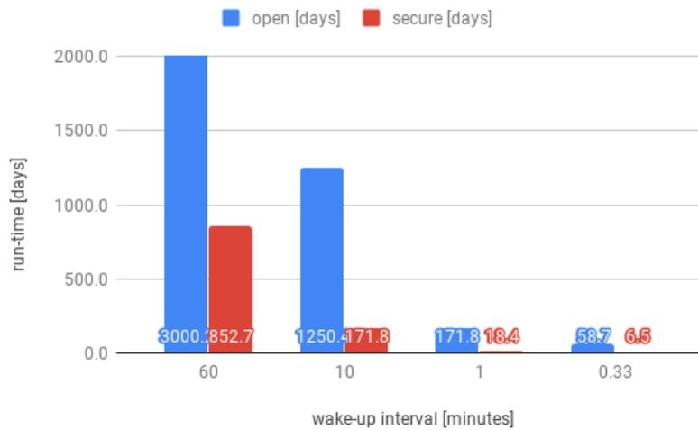
Abbildung 15: ESP8266 Deep-Sleep Laufzeit bei periodischem wecken mit einem 1000mAh Akku (Blau = offenes W-Lan Rot= Sicheres W-Lan) (13)
